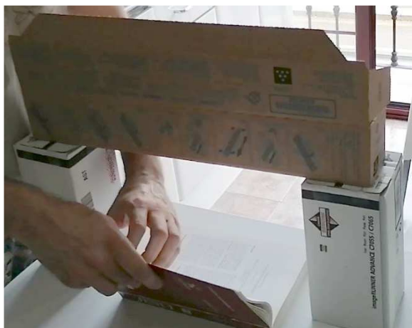
Figura 1: Primer prototipo de soporte para digitalización. Dentro de la caja superior está el teléfono móvil para realizar las fotos.
