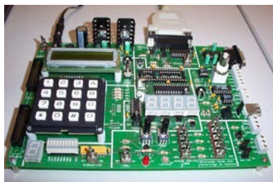
Figura 1. Plataforma de desarrollo basada en microcontroladores PIC (EduPIC).
