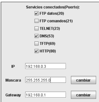
Figura 4. Componente GUI para configurar la tarjeta de red de un PC.
