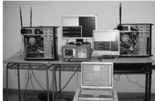
Figura 2: Foto del banco de pruebas mostrando el PC Tx, el PC Rx, y gtTAL ejecutándose en un portátil.
