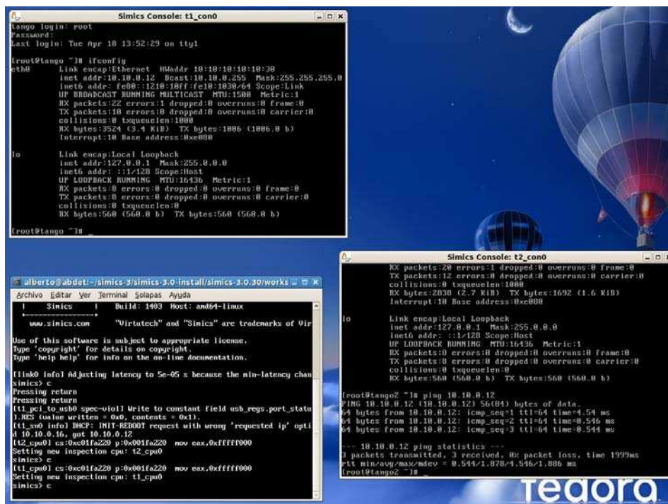
Figura 1: Dos equipos simulados por Simics conectados entre sí por un enlace de red simulado.
