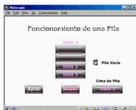
Figura 9. Desapilando un dato
