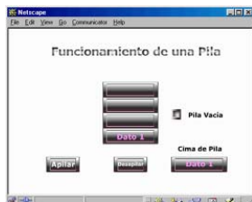
Figura 7. Apilado de un dato
