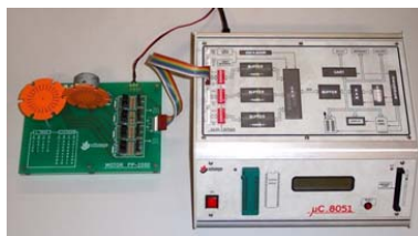
Figura 10. Equipo MCA-51, de Alecop [1], para prácticas de E/S con 8051, conectado a la tarjeta MOTOR PP-2000, con dos motores paso-a-paso.
